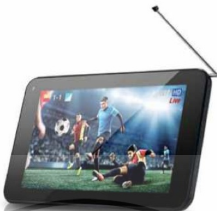
รูปที่ 2.21 สายอากาศและเครื่องรับสำหรับโทรทัศน์ภาคพื้นดินระบบดิจิทัลรุ่นที่ 2 ชนิดพกพาและเคลื่อนที่ [9]
