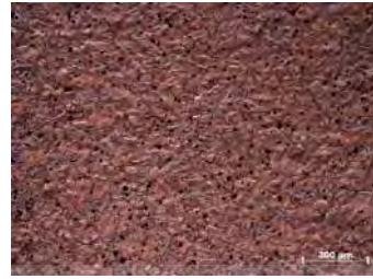
รูปที่ 10 โครงสร้างทางจุลภาคของเหล็กกล้าไร้สนิมที่ขนาดเกรนเริ่มต้น 80 ไมโครเมตร ที่ผ่านการดิงระยะยืด 40% และอบอ่อนที่ 1030 องศาเซลเซียส 10 นาที
