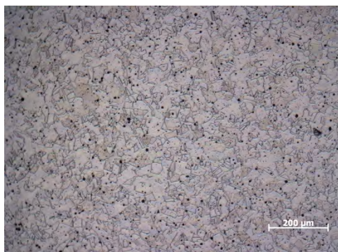
รูป ก) อบอ่อน 1000 องศาเซลเซียส 10 นาที รูป ข) อบอ่อน 1100 องศาเซลเซียส 10 นาที รูปที่ 5.15 โครงสร้างทางจุลภาคของเหล็กกล้าไร้สนิมที่ขนาดเกรนเริ่มต้น 40 ไมโครเมตร ที่ผ่านการ ดิ่งระยะยัด 40%
