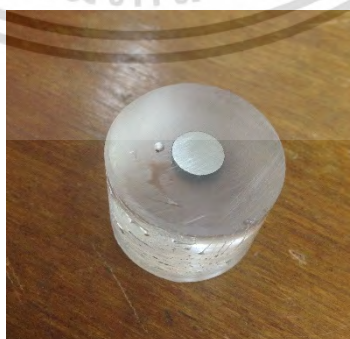
รูปที่ 4.16 แสดงการขัดชิ้นงานด้วยกระดาษทราย
