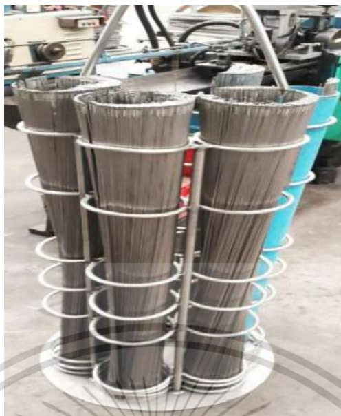
รูปที่ 3.6 ลักษณะของลวดที่ใส่กระเช้า
