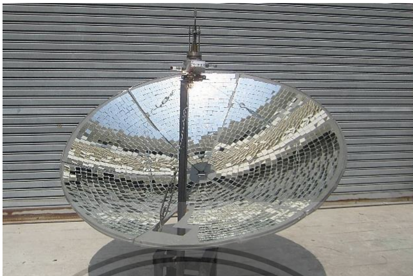
รูปที่ 6.5 จานรวมแสงที่มีการใช้งานร่วมกับเครื่องยนต์สเตอร์ลิงในห้องปฏิบัติการ
