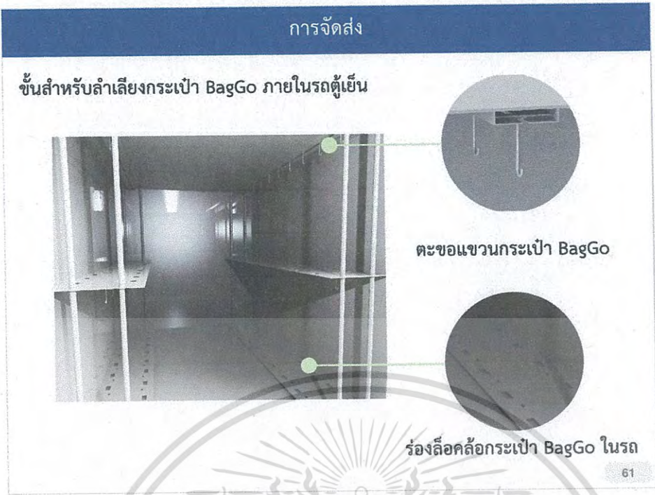
ภาพที่ 225 ชั้นวางกระเป๋า BagGo ภายในรถตู้เย็น
