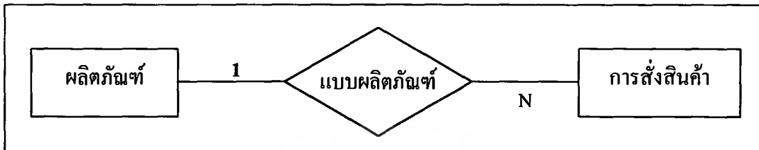
ภาพที่ 13 โมเดล E-R แสดงความสัมพันธ์ระหว่างเอนิตี ผลิตภัณฑ์และการสั่งซื้อ
