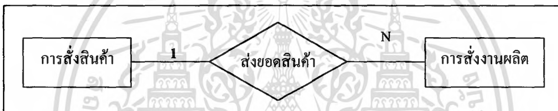
ภาพที่ 14 โมเดล E-R แสดงความสัมพันธ์ระหว่างเอนิตี การสั่งซื้อและการสั่งงานผลิต
