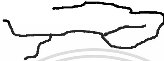
รูปที่ 2.2 โครงสร้างสายโซ่ตรงของ HDPE [17]
