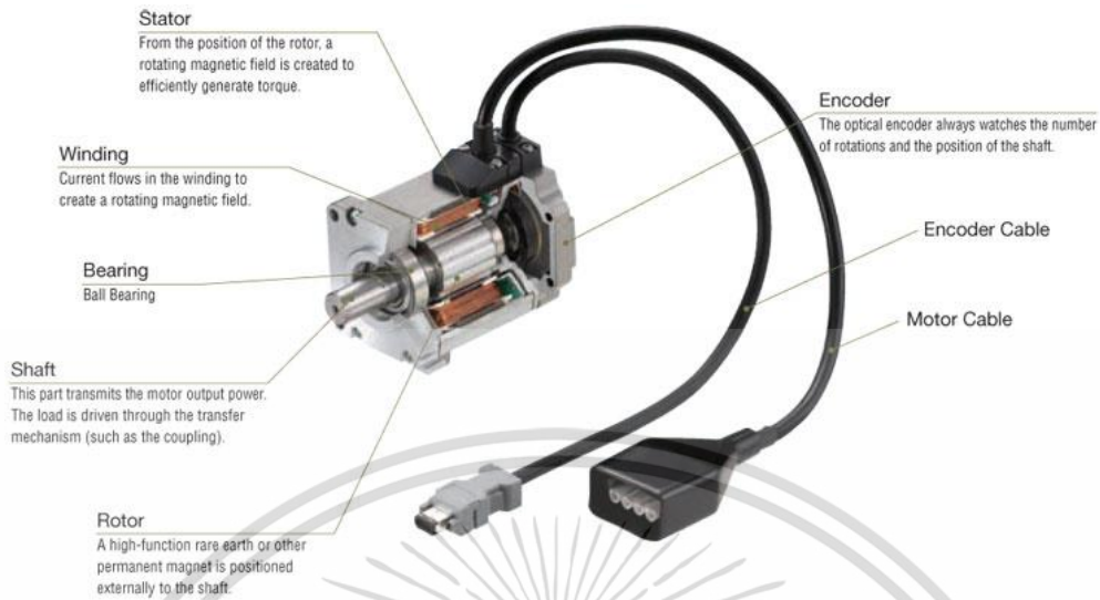
รูปที่ 2.37 ส่วนประกอบของเอซีเซอร์โวมอเตอร์
