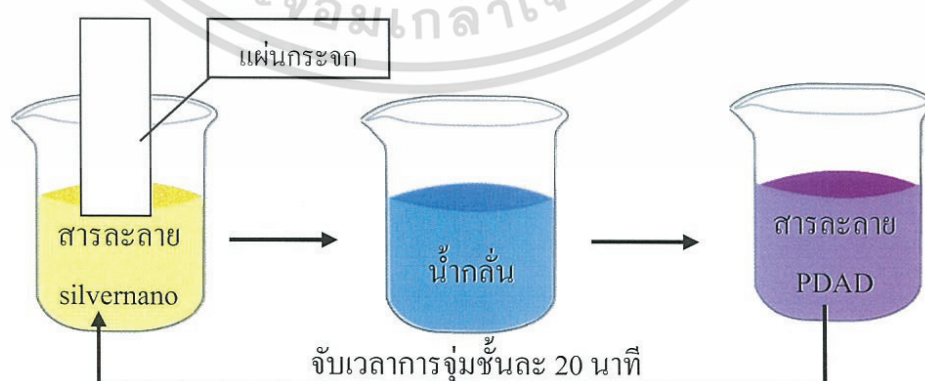
รูปที่ 3.10 วิธีการเตรียมแผ่นฟิล์มด้วยสารละลายอนุภาคเงินระดับนาโนให้จำนวนชั้นของฟิล์มแตกต่างกัน
