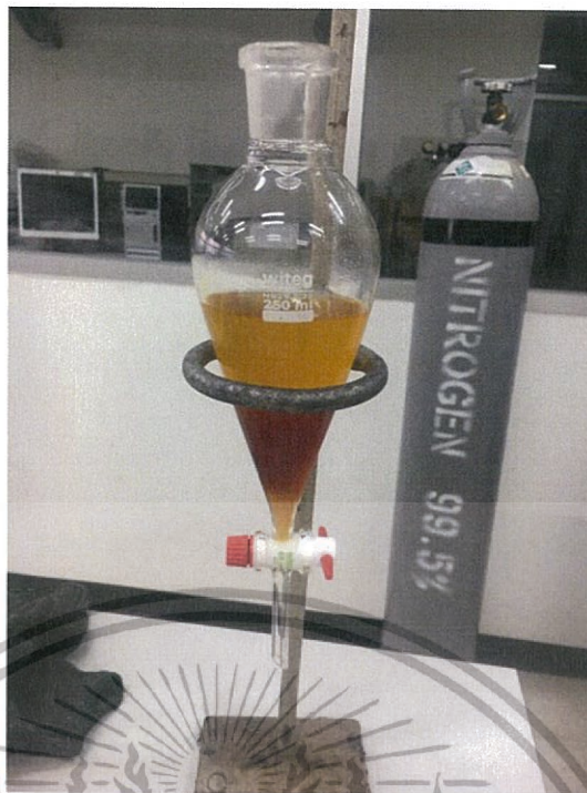
รูปที่ 3.7 แสดงการแยกชั้นของเมทิลเอสเทอร์และกลีเซอรอลในกรวยแยก
