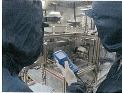
ภาพที่ 3.8 ขณะปฏิบัติการวัดความเร็วของอากาศขณะเครื่องจักรทำงาน
