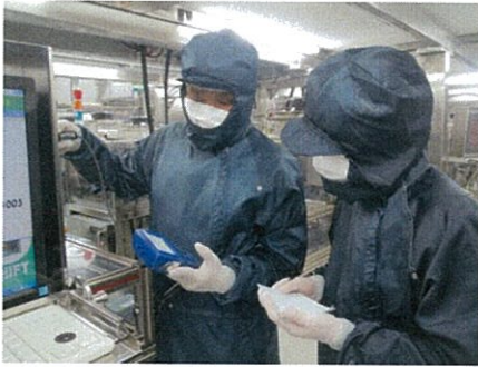
ภาพที่ 3.8 ขณะปฏิบัติการวัดความเร็วของอากาศขณะเครื่องจักรทำงาน
