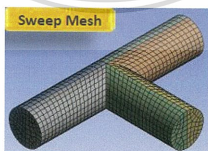
ภาพที่ 2.10 แสดงแบบจำลองที่สามารถเมชแบบSweepได้
