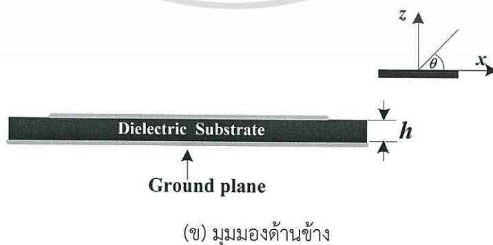
รูปที่ 2.7 โครงสร้างของสายอากาศไมโครสตริปวงกลมที่มีการกระตุ้นด้วยสี่จุดป้อนตั้งต้น
