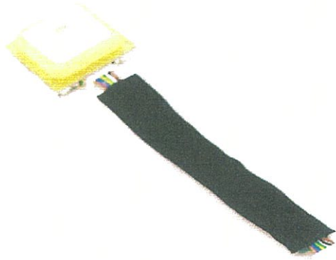
รูปที่ 2.4 ตัวรับสัญญาณจีพีเอสยี่ห้อ ETek GPSรุ่น EB-85A
