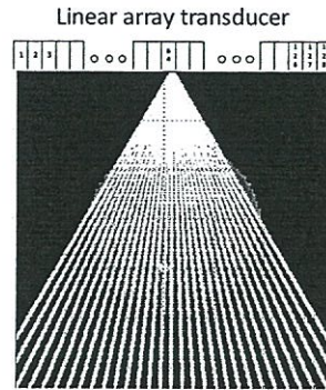
รูปที่ 5.4 การแพร่กระจายของคลื่นอัลตราซาวด์จากทรานสดิวเซอร์อิลิเมนต์แต่ละอัน
