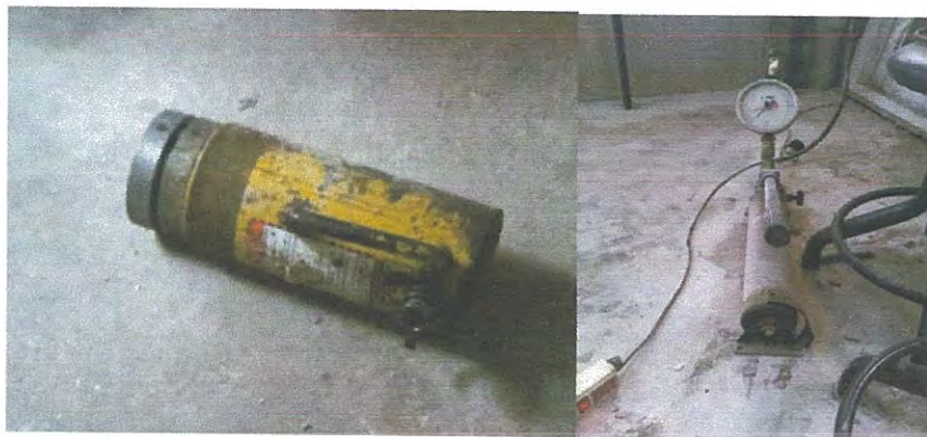
รูปที่ 3.7 แสดงเครื่องมือ Hydraulic Jack ที่ใช้ทำการทดสอบ โดยเพิ่มขนาดแรงที่ละ 50 kN
