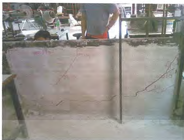
รูปที่ 3.16 แสดงการแตกร้าวของกำแพงอิฐมวลเบาเติมช่องตัวอย่างที่ 2
