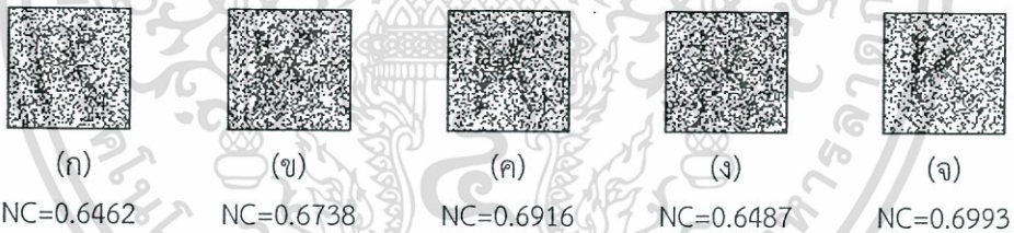
รูปที่ 5.38 ลายน้ำที่กู้คืนมาจากภาพที่ผ่านการโจมตีด้วยตัวกรองความถี่ต่ำผ่านขนาด 5 \times 5 ตามวิธีของ Shieh (ก) ภาพ Lena (ข) ภาพ Peppers (ค) ภาพ Boat (ง) ภาพ Airplane และ (จ) ภาพ Mandrill
