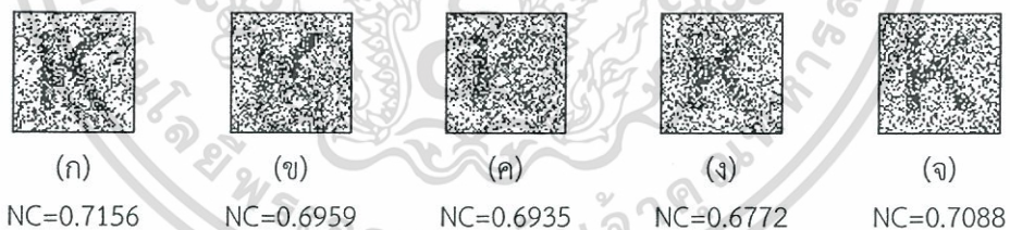
รูปที่ 5.61 ลายน้ำที่กู้คืนมาจากภาพที่ผ่านการโจมตีด้วยตัวกรองความถี่ต่ำผ่านขนาด 5 \times 5 ตามวิธีของ Wei (ก) ภาพ Lena (ข) ภาพ Peppers (ค) ภาพ Boat (ง) ภาพ Airplane และ (จ) ภาพ Mandrill
