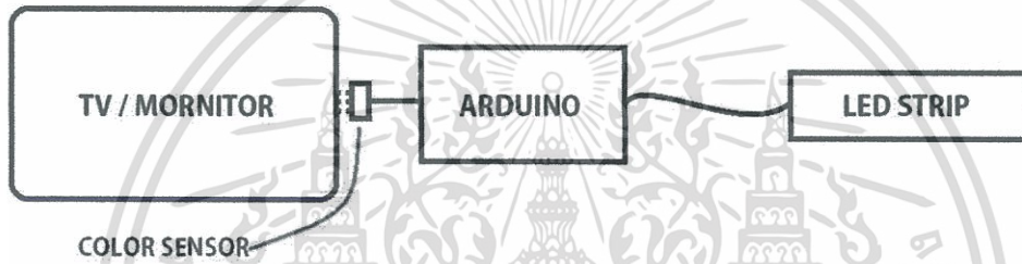
รูปที่ 4.1 รูปแสดงแผนภาพการเชื่อมต่อของระบบ
