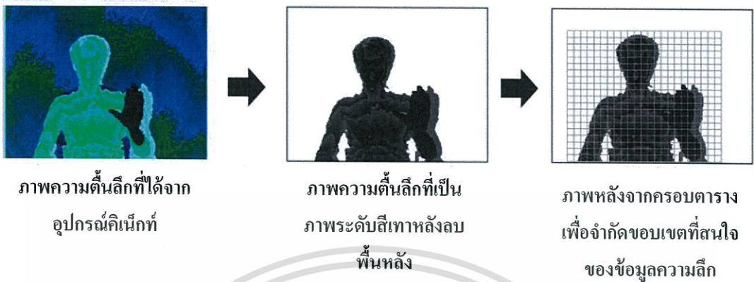
รูปที่ 3.1 กระบวนการหาขอบเขตที่สนใจของข้อมูลความลึก
