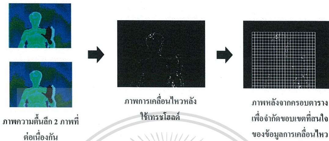
รูปที่ 3.3 กระบวนการหาขอบเขตที่สนใจของข้อมูลการเคลื่อนไหว
