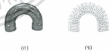
รูปที่ 2 ก) ท่อทองแดงโค้ง ข) แสดงให้เห็นภายในท่อทองแดงโค้ง ซึ่งมีท่อทองแดงขนาดเล็กขดแบบสปริงอยู่ภายในช่องว่างระหว่างท่อสามารถบรรจุสารเก็บความเย็นได้
