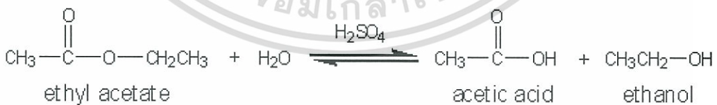
รูปที่ 2.8 ปฏิกิริยาไฮโดรไลซิสของเอทิลอะซิเตต [24]
