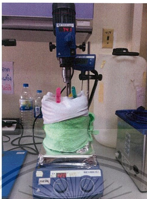
รูปที่ 3.4 การเตรียมสารละลายพอลิไวนิลแอลกอฮอล์ดัดแปรด้วยกรดโอเลอิก
