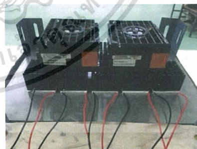
รูปที่ 3.2 ชุดระบายความร้อนด้วยฮีทซิงค์และพัดลม
