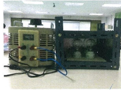
รูปที่ 3.1 ชุดจำลองอุณหภูมิด้านร้อน
