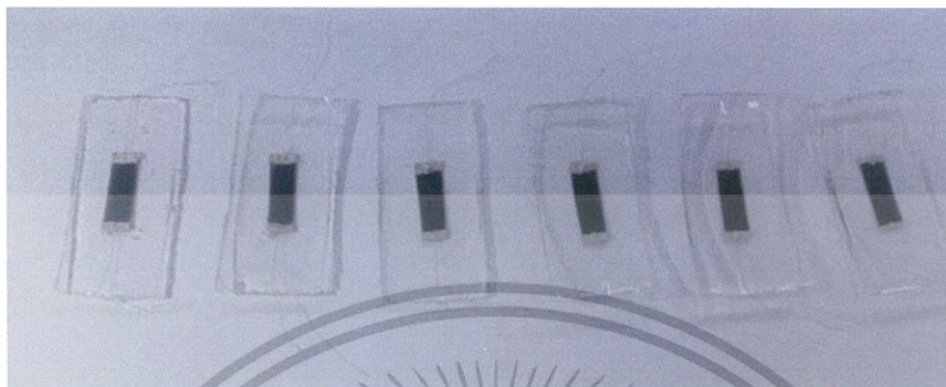
รูปที่ 3.34 เซ็นเซอร์วัดแรงตึงเครียด(Strain sensor) รุ่นที่4 ในการนำไปประยุกต์ใช้กับแขนกล
