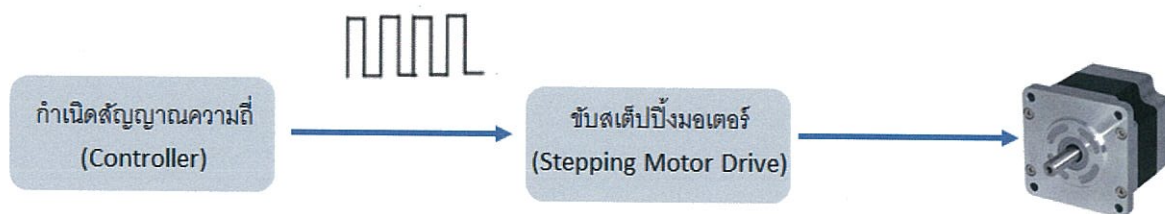
รูปที่ 2.3 แผงผังการทำงานของ Stepper Motor
