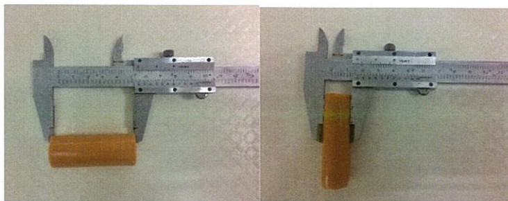
รูปที่ 3.3 การเตรียมตัวอย่างไส้กรอก (ก.) ตัวอย่างไส้กรอกทั้ง 3 ขนาด (ข.) การวัดขนาดตัวอย่างไส้กรอกด้วยเวอร์เนียคาลิเปอร์
