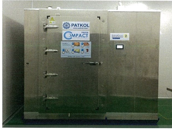
รูปที่ 3.7 เครื่องแช่เยือกแข็งแบบลมเป่าที่ใช้ในการทดลอง
