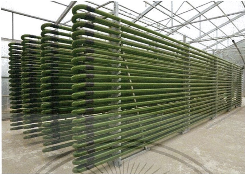
รูปที่ 2.4 การเพาะเลี้ยงสาหร่ายในระบบปิดในถังปฏิกรณ์ชีวภาพชนิดท่อแบบให้แสง ที่มา: นพ.วัลลภ, 2558
