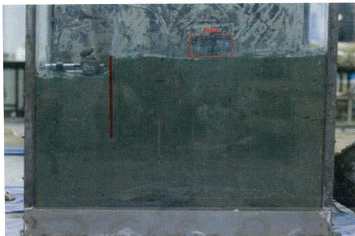
รูปที่ 4.3 การทดลองกรณีที่ 2 น้ำหนักบนผิวดิน 10 กิโลกรัม ที่ระยะห่าง 30 เซนติเมตร
