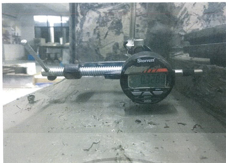
รูปที่ 4.18 ค่าการเคลื่อนตัวของกรณีที่ 9 น้ำหนักบนผิวดิน 40 กิโลกรัม ที่ระยะห่าง 15 เซนติเมตร
