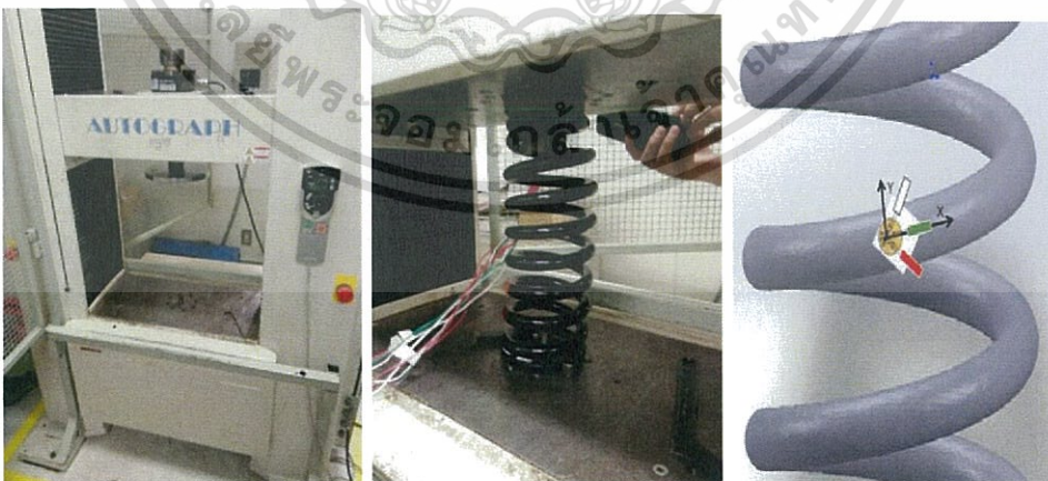
รูปที่ 3.7 เครื่องทดสอบแรงกด UTM AGS-X Shimadzu และการติดตั้งสเตอรนเกจ
