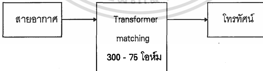
รูป 3-2 แสดงการวัดอิมพีแดนซ์จากสายอากาศเท่ากับ 300 โอห์ม
