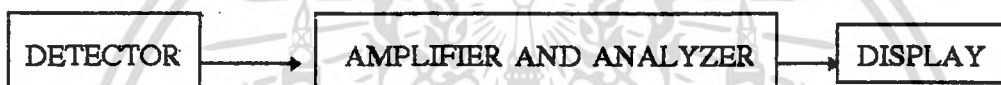
รูปที่ 2.9 แสดงแผนภาพหลักการวัดระดับเสียง
