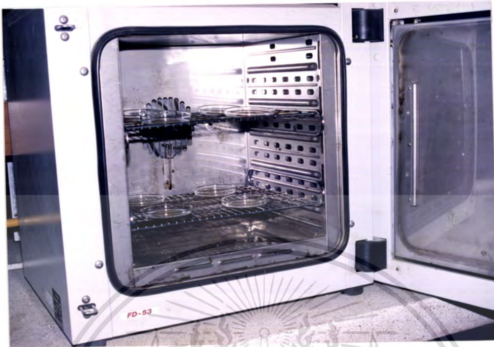
รูปที่ 3.8 การวางเพลทในตู้อบลมร้อน เพื่อทำเซลล์แห้ง
