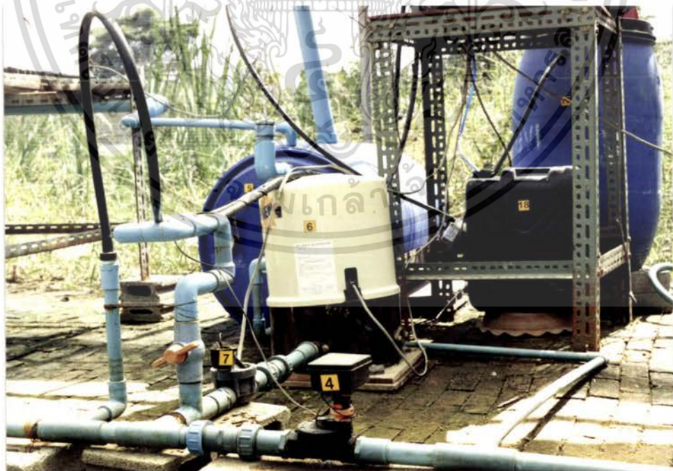
ภาพที่ 4 แสดงระบบการจ่ายสารละลายธาตุอาหาร
