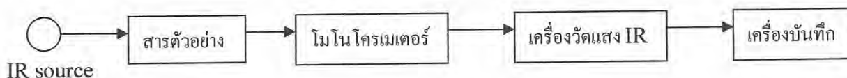
รูปที่ 2.3 แสดงส่วนประกอบของเครื่องฟูรีเออร์ทรานสฟอร์ม อินฟราเรดสเปกโทรมิเตอร์
