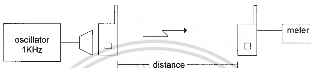
รูปที่ 4.11 การวัดระยะห่างของวิทยุมือถือที่ทำการติดต่อกันโดยตรง
