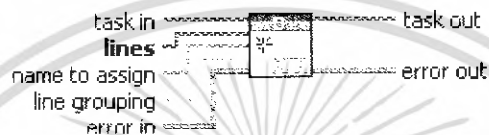
รูปที่ 3.13 DAQmxBase Create Virtual Channel Digital Output
