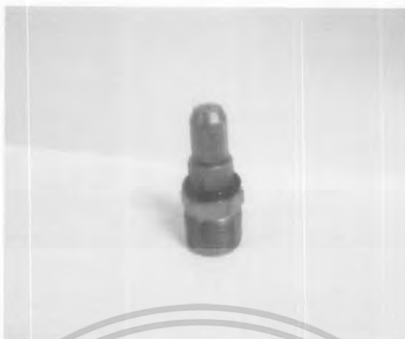
รูปที่ 4.17 แสดงหัวฉีดยาน้ำ วัสดุทองเหลือง ขนาดเส้นผ่านศูนย์กลางหัวฉีด 1 มิลลิเมตร
