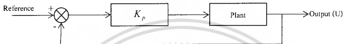
รูปที่ 2.21 โครงสร้างของตัวควบคุมแบบสัดส่วน
