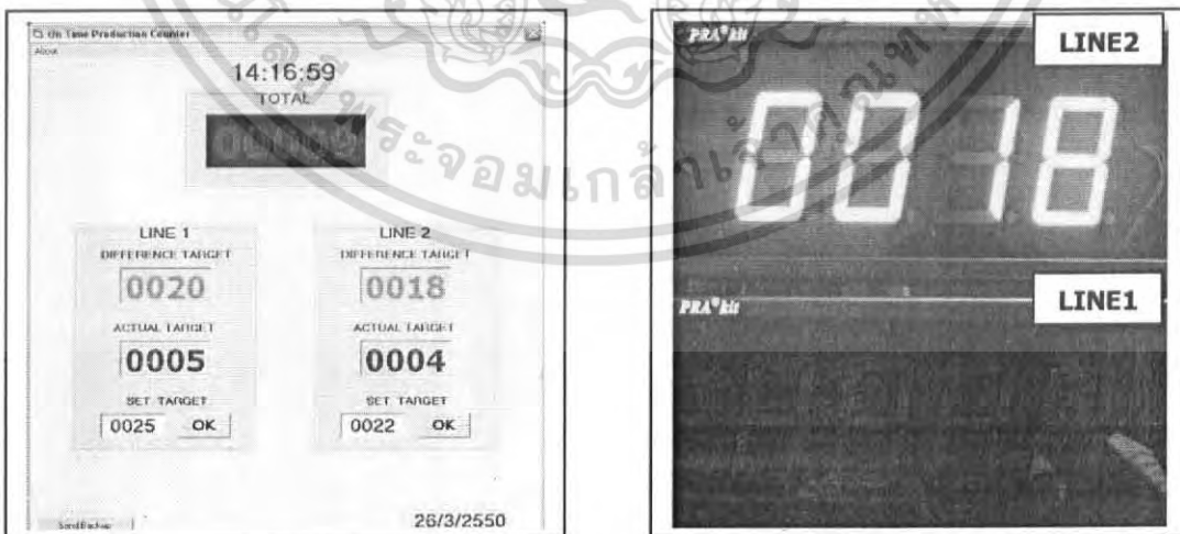
(a) DIFFERENCE TARGET LINE1 เป็น “0020” DIFFERENCE TARGET LINE2 เป็น “0018”
