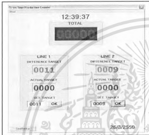
(a) กำหนดค่าเป้าหมาย LINE1 เป็น “0011” กำหนดค่าเป้าหมาย LINE2 เป็น “0009” (b) การแสดงผลที่ป้ายนับจำนวนผลการผลิต หลังจากการตั้งค่าจาก LINE1 และ LINE2 รูปที่ 4.10 กำหนดค่าเป้าหมายทั้งใน LINE1 และ LINE2 และการแสดงผลที่ป้ายนับจำนวนการผลิต
