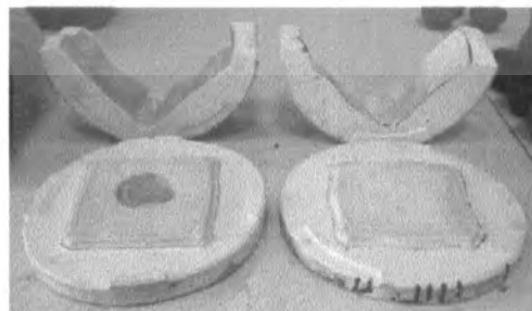
ภาพที่ 4.31 แม่พิมพ์ฐานที่ใส่กล่องกระดาษทิชชู
