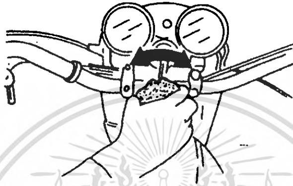
รูปที่ 5-33 การปรับแผ่นความฝืด
