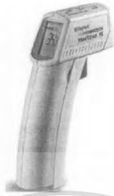
รูปที่ 3.15 เครื่องวัดอุณหภูมิด้วยแสงอินฟราเรด
