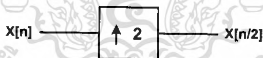
รูปที่ 3.8 บล็อกไคอะแกรมของวงจรเพิ่มค่าตัวอย่าง
