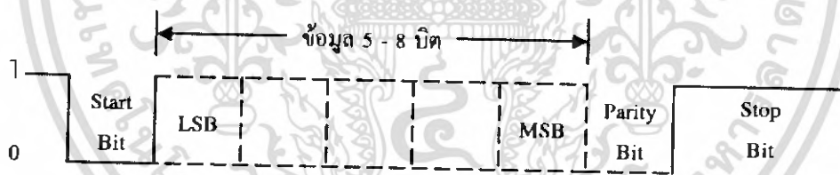
รูปที่ 2.3 การจัดเรียงบิตในการส่งแบบอะซิงโครนัส
