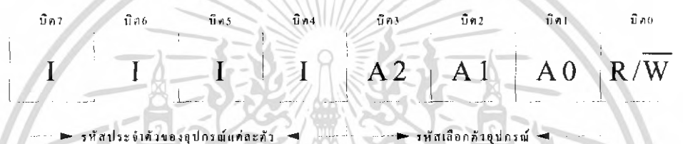
รูปที่ 2.25 ลักษณะของคอนโทรลไบต์ของไอสแควชิ
