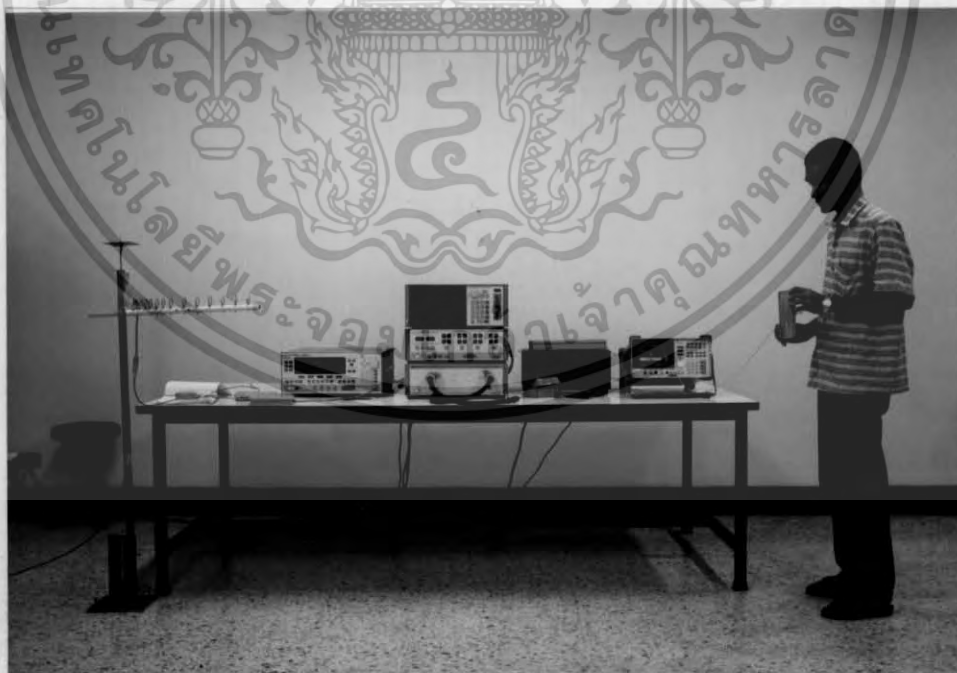
รูปที่ 4.14 วิธีการวัดแพทเทอร์นการแพร่กระจายคลื่นของสายอากาศ
