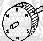
รูปที่ 2.5.3 ลักษณะโรเตอร์ที่เป็นแม่เหล็กถาวรของมอเตอร์
