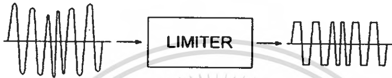
รูปที่ 2.10 วงจรลิมิตเตอร์จะขจัดคอนอส์และการเปลี่ยนแปลงทางแอมพลิจูดของสัญญาณ FM
