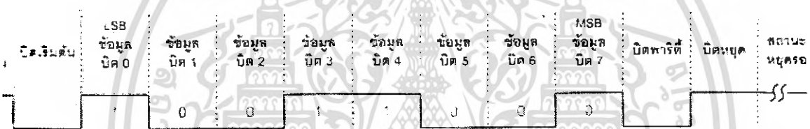
รูปที่ 4.3 รูปแบบอย่างง่ายที่สุดของข้อมูลอนุกรมแบบอะซิงโครนัส
