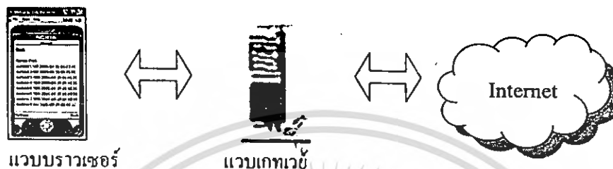
รูปที่ 2.22 การจำลองการเชื่อมต่อของแวนบราวเซอร์เข้าสู่เครือข่ายอินเทอร์เน็ต
