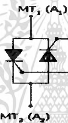
รูปที่ 2.18 สัญลักษณ์และรูปร่างของไตรแอก
