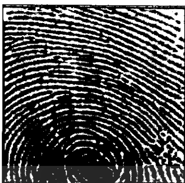
รูปที่ 2.9 ผลการอ่านลายนิ้วมือที่ใช้หลักการสะท้อนกลับหมดของแสงและหลักการของแสงที่หายไปอย่างรวดเร็ว
